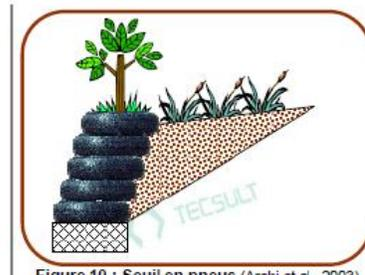
Figure 10 : Seuil en pneus (Arabi et al., 2003)
